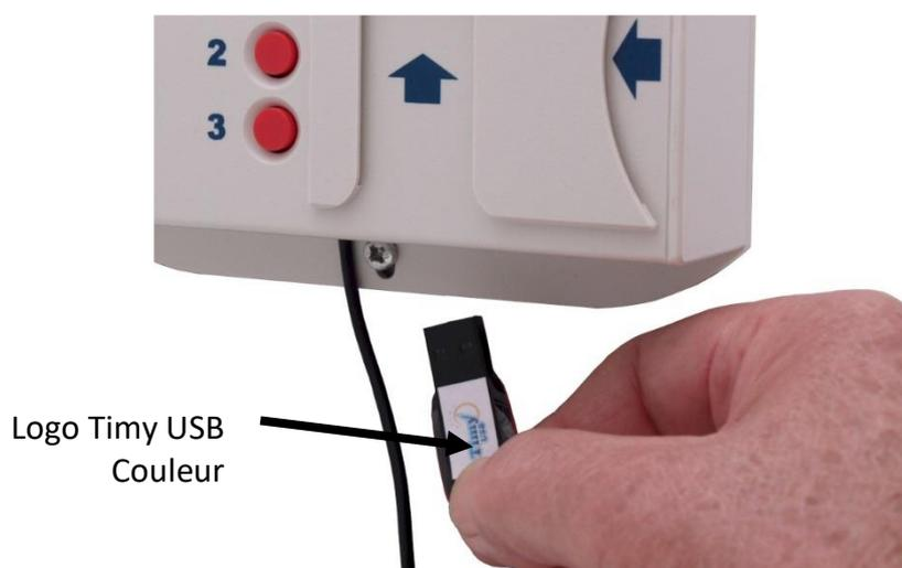
Le fonctionnement sur piles ou secteur est identique : insérez la clé USB dans la prise, puis appuyez sur le bouton “3” (en mode piles la pointeuse s’allume automatiquement).
