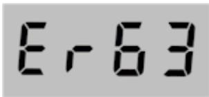
Les codes erreur sont regroupés dans une série “Er5x” et une série “Er6x”. Sans aller dans des détails trop techniques, la série “5x” indique un *problème matériel avec la clé*, et la série “6x” plutôt un problème de *formatage de la clé*.
