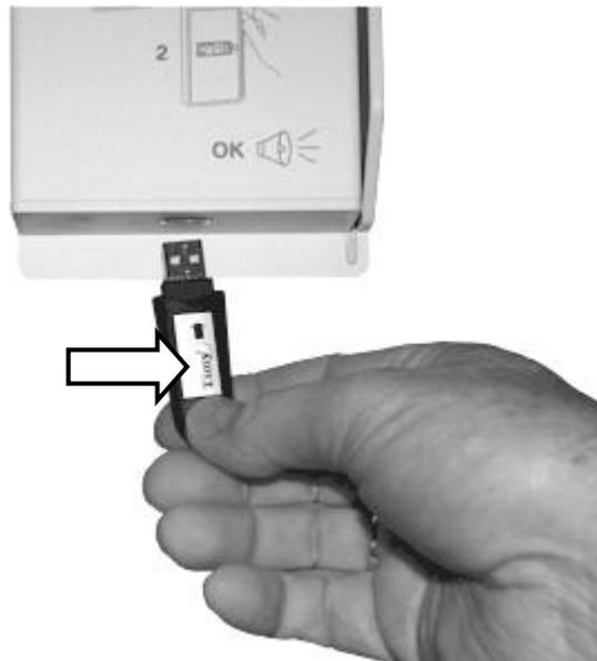
Fonctionnement sur piles : Insérez la clé USB dans la prise puis appuyez sur le bouton rouge pour réveiller la badgeuse.
