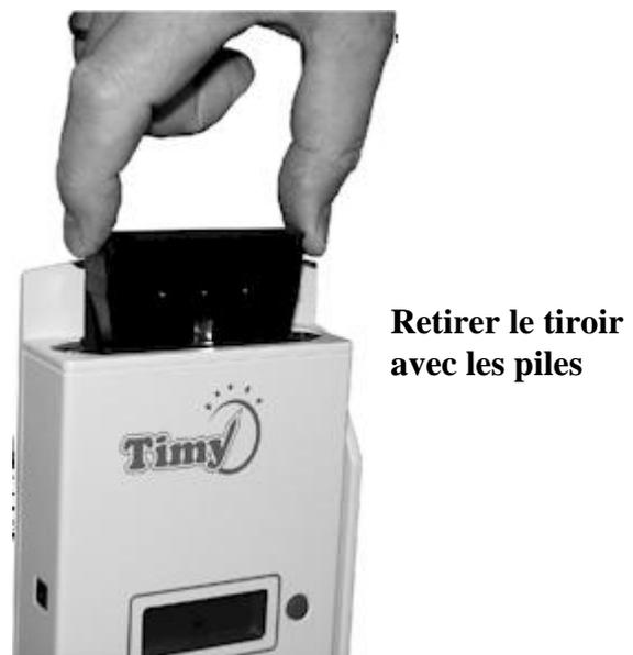
Retirez les piles usées et remplacez-les par des piles alcalines neuves. Respectez le sens des piles ! Glisser le tiroir dans son logement (piles face au mur). Bien enfoncer le tiroir (l'engagement des clips produit un "clic"). L'horloge de la badgeuse continuera à fonctionner pendant au moins TROIS MINUTES sans piles. Au-delà de cette limite il y a risque d'arrêt de l'horloge nécessitant une mise à l'heure complète lors de la remise en route.
